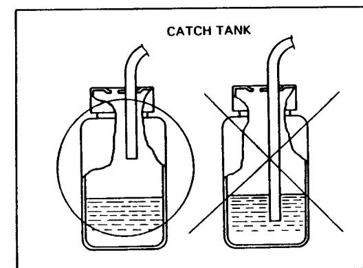
③ フューエルタンクのキャッチタンクはレギュレーションにより250cc以上の容積を確保しなければならない。
